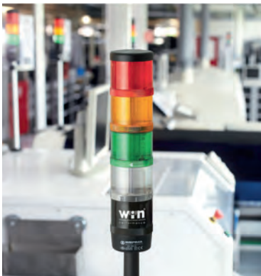
Un système extensible à tout moment : Des « WIN transmitter » supplémentaires vous permettent d'intégrer jusqu'à 50 machines dans le réseau
