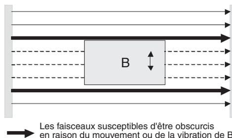
Le système F3S-TGR-CL inclut différents réglages de tolérance de faisceau via les commutateurs de sélection afin de couvrir ces exigences :
