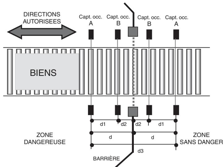
Ce mode d'activation de l'occultation permet un transport bidirectionnel des matériaux.
