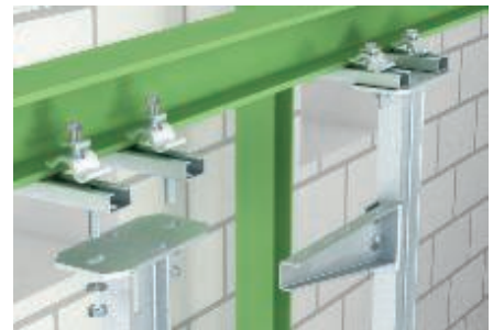
Montage sur IPN des pendants en I avec un rail en C et les crapauds type TKL-L-25. Cheminement perpendiculaire à l'IPN.
