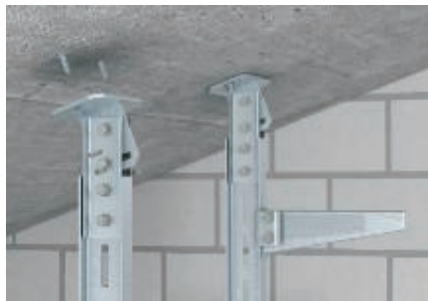
Montage de la semelle variable type KI 8 VLK (rotation de 90°) sur un plafond oblique en béton, à l'aide de cheville à expansion type FAZ II.
